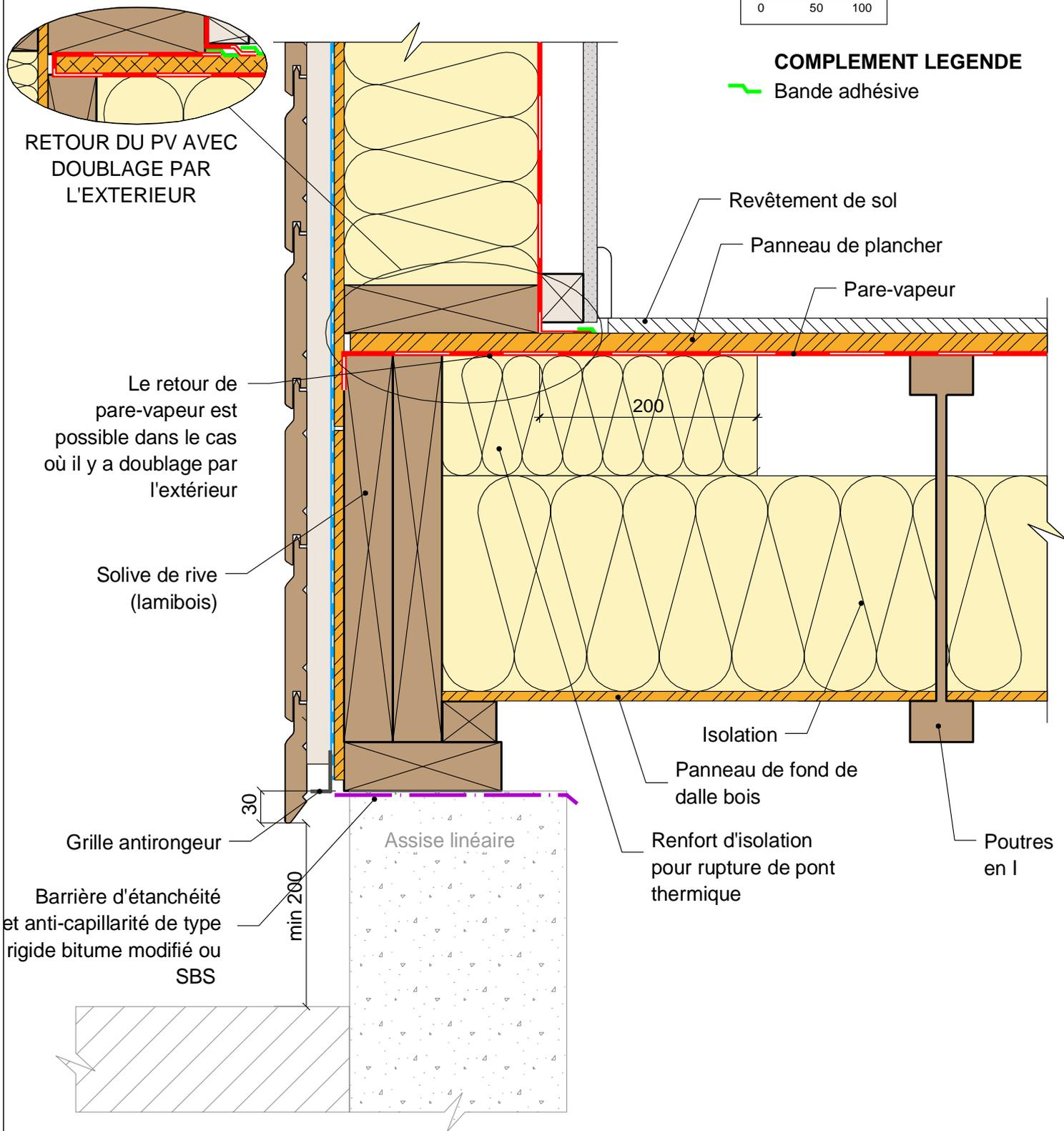
**PLANCHER BAS TYPE 2: Dépôt de bandes de panneau sur semelle basse des poutres en I**
