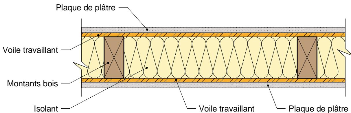
**MUR PORTEUR INTERIEUR TYPE 4: Mur simple ossature -
