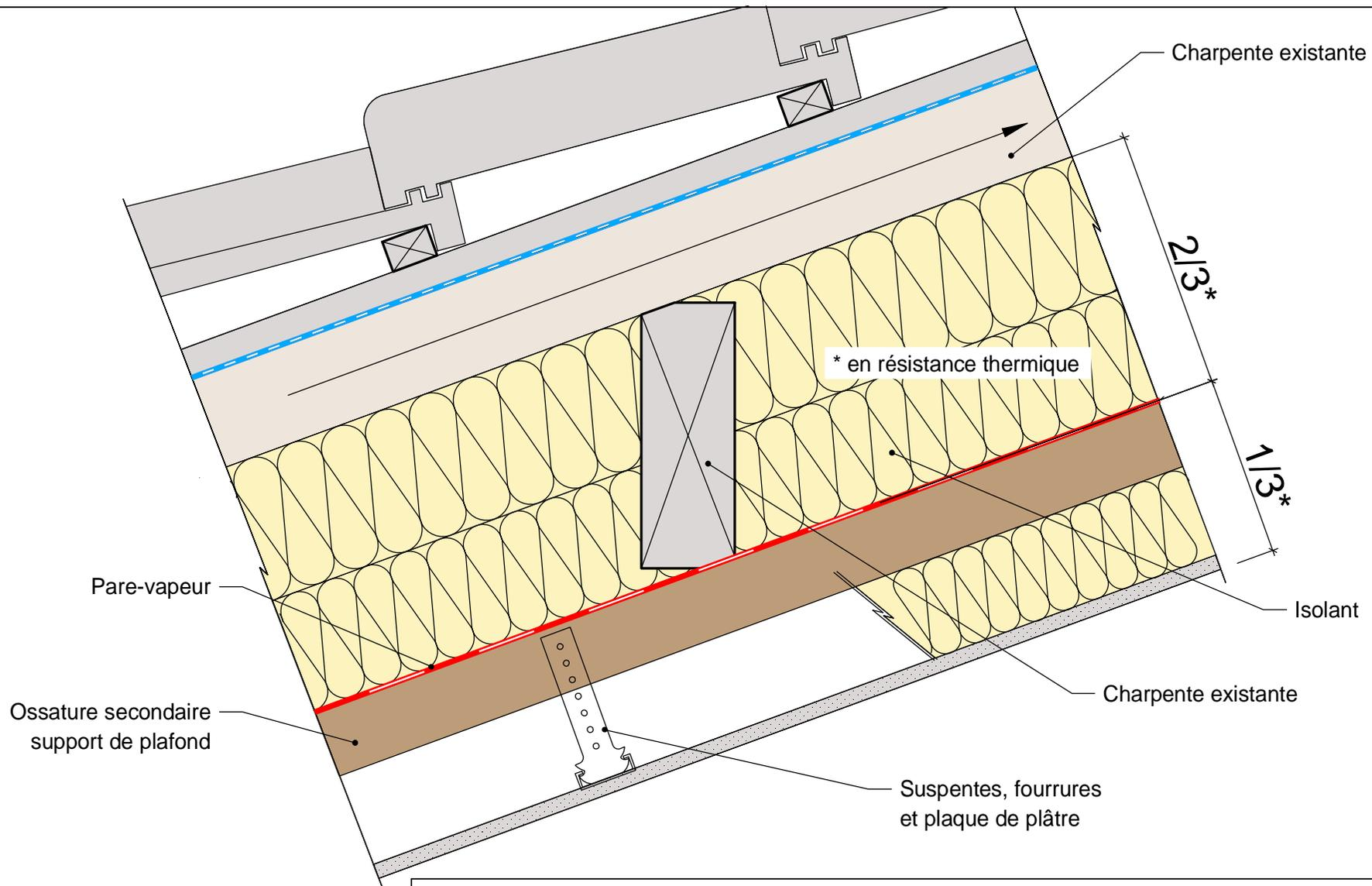
NOTA: Adéquation poids de l'isolant et résistance à la déchirure au clou du pare-vapeur à maîtriser
