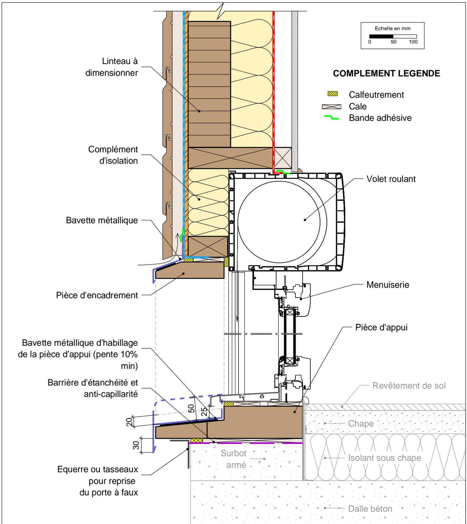
**MUR EXTERIEUR TYPE 1: Isolant en âme - voile travaillant extérieur**
