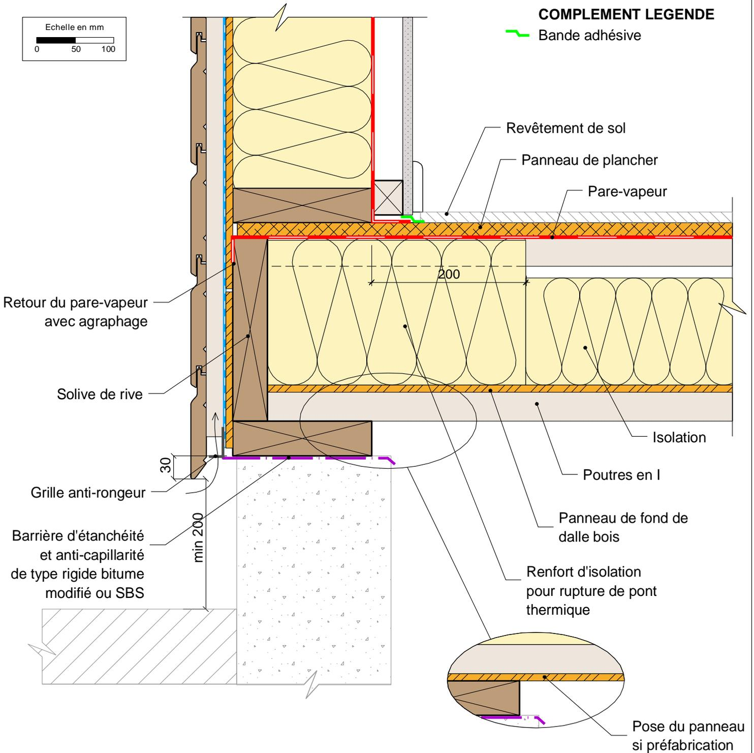
**MUR EXTERIEUR TYPE 1: Isolant en âme - voile travaillant extérieur**
